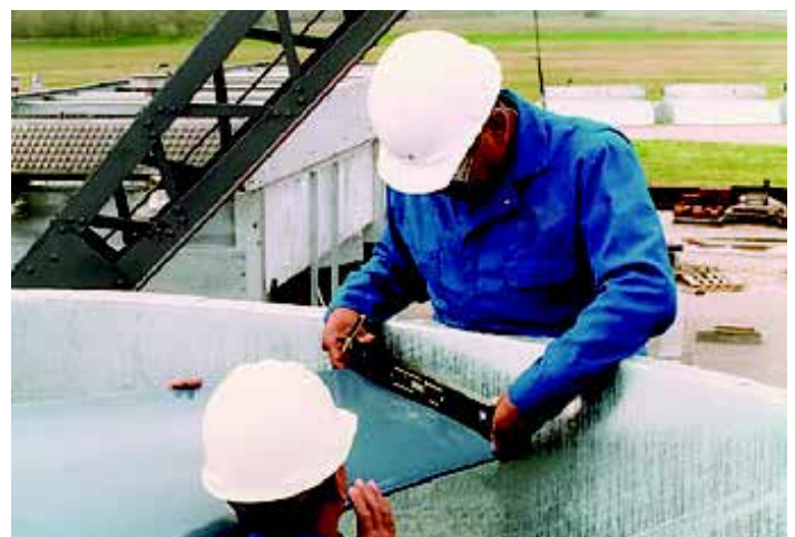
FIG. 1 Il est important de savoir où prendre la lecture du pas.
